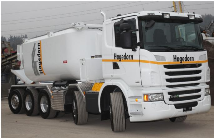
grâce à l'essieu porteur dirigeable et levable extrêmement manœuvrable, l'un des deux nouveaux Scania G480 LB 10x4\*6 avec benne à béton Moser.
