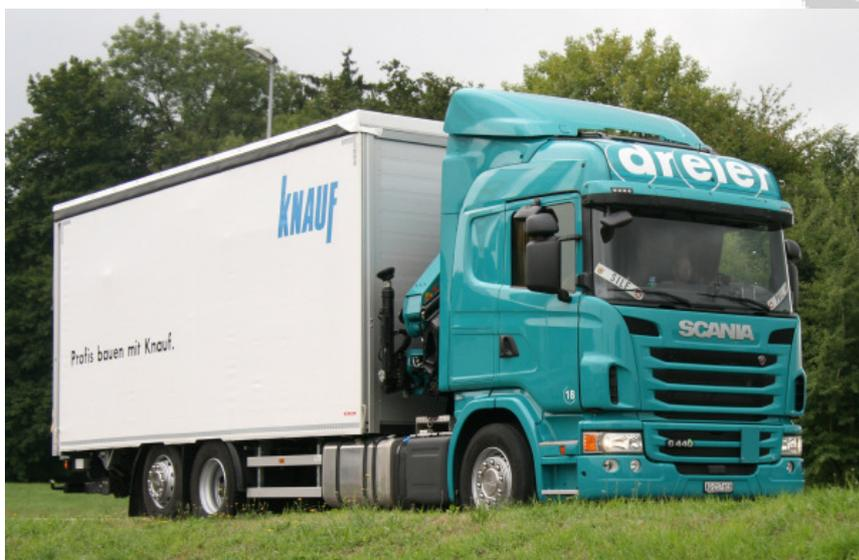
Der neue Scania G440 LB 6x2\*4 verfügt hinter dem Fahrerhaus über einen 23,5 m/t Kran.
