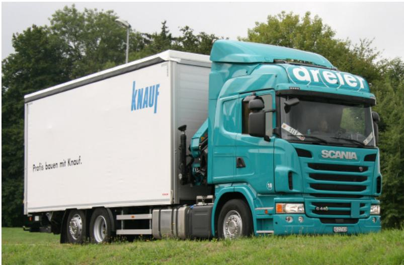
Le nouveau Scania G440 LB 6x2\*4 dispose d'une grue à 23,5 m/t derrière la cabine conducteur.
