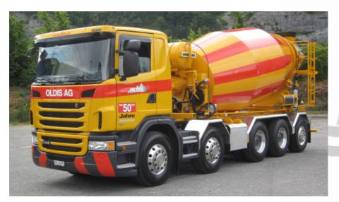
Dank Wechselsystem ist der neue Scania 5-Achser innert kürzester Zeit als Drehmischer unterwegs. Dank leichtem Scania Fahrgestell gar noch mit etwas mehr Beton!
