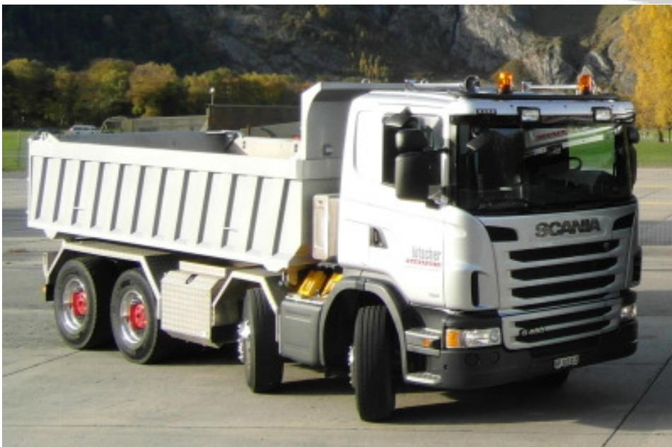
Le nouveau Scania G480 CB 8x4 dispose d'une benne basculante bilatérale et d'une cabine de jour CG16.
