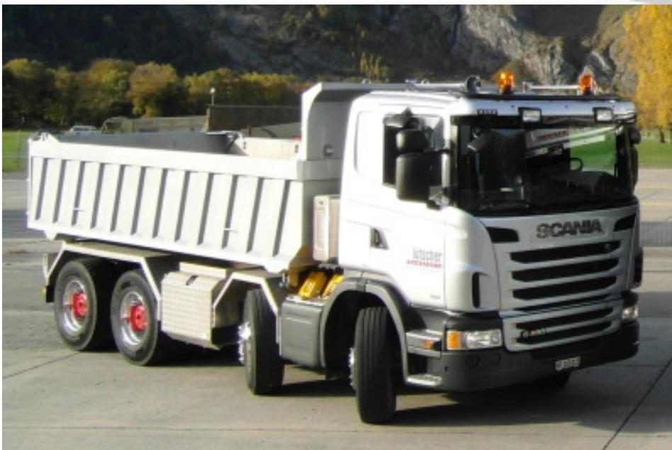
Der neue Scania G480 CB 8x4 verfügt als Aufbau einen 2-Seitenkipper und CG16 Tageskabine.
