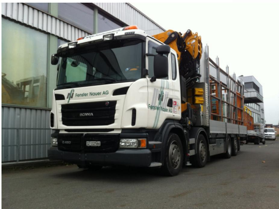
A part voler, le nouveau camion à quatre essieux de la Fenster Nauer AG à Samstagern sait presque tout faire. Il dispose d'une suspension pneumatique avant et arrière et d'un support quintuple pour la grue.
