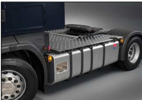
*Ein 40-t-Sattelzug mit dem 13-Liter-Reihensechszylinder von Scania mit 410 PS und Euro 6 kann theoretisch mit Diesel in nur einen 900-Liter-Aluminiumtank wie hier auf dem Bild 3'700 km zurücklegen.*
