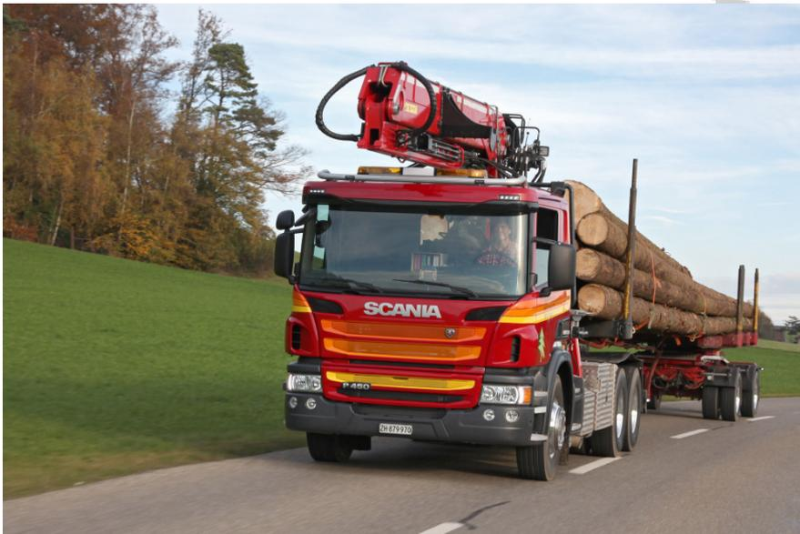
Der neue Scania P450 LB 6x4 unterwegs mit Langholz zur Weiterverarbeitung. Trotz tiefer P-Baureihe stehen dem Fahrer satte 450 PS und ein Drehmoment von 2'350 Nm zur Verfügung. Bei solchen Ladungen ist jedes am Fahrzeug eingesparte Kilogramm wichtig.
