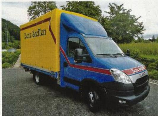
Deutlich sichtbar: Die Windleitsysteme an Rändern und Seiten von Nutzfahrzeugen. Sie reduzieren den Luftwiderstand und damit den Treibstoffverbrauch.
